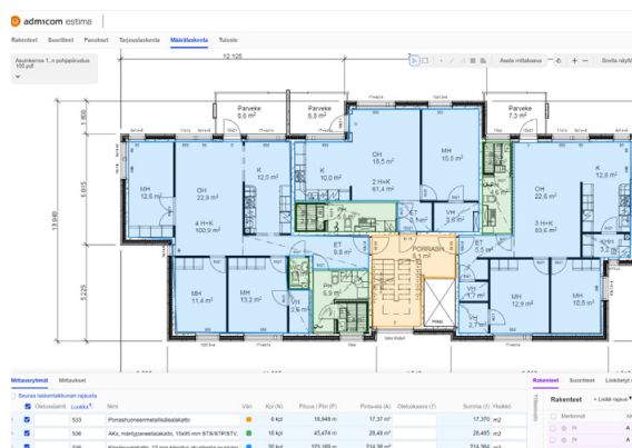
Kuva 2. Kuvassa mitattu kolme rakennusosaa, jotka ovat kaikki erilaisia alakattoja. Värikorostus auttaa varmistamaan, että kaikki alakattopinnat on mitattu.
